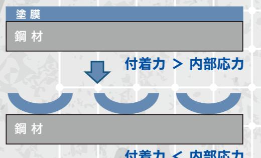
塗膜の内部応力が増大する、もしくは付着力が低下した場合に塗膜に割れや剥がれが生じる。
